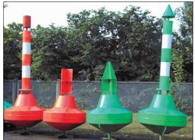
► Abb. 3.4 Tonnen mit Oktaeder- und BR4-180-Reflektoren (im Kunststoffrohr)
