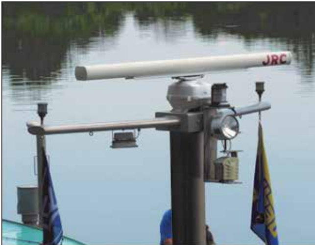
■ Abb. 3.3 Bugradar auf Frachtschiff und Containerschiff
